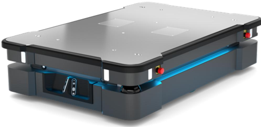
El MiR500 ha sido diseñado para automatizar el transporte de palés y de cargas pesadas en diferentes sectores. Con una carga útil de 500 kg y una superficie de 1350x920 mm, el MiR500 es un robot móvil autónomo colaborativo grande y robusto.
